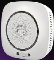
Detector de Fuga/Escape de Gas Propano/Natural y Coal Gas, con conexión directa a WiFi 2.4GHz, no necesita Hub, Voltaje de operación 110VAC, con salida 12V para Valvulas de gas externas tipo Solenoide y Salida de contacto seco ( Normalmente Cerrado ) para Sistema de Alarma externo.
